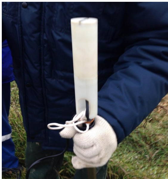
Slika 6b, 3-osni senzor udaljen od površine. Osim senzora u kućištu je i elektronika za oba senzora.
