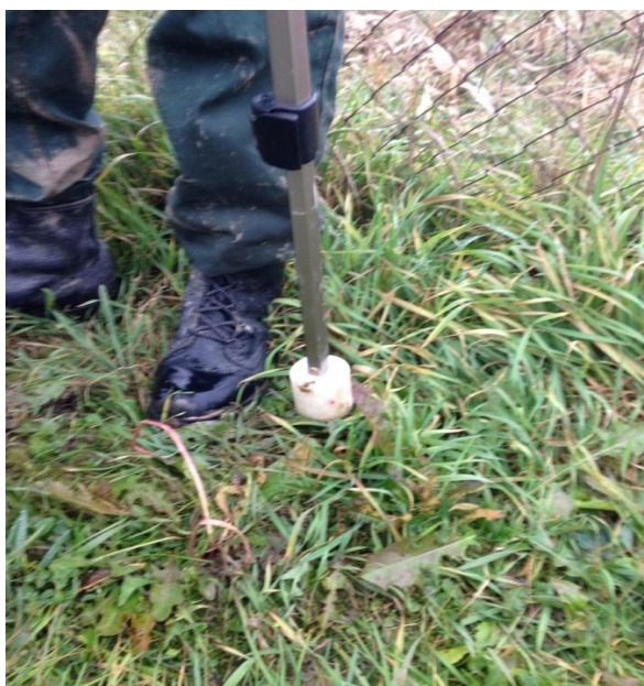
Slika 6a, 3-osni senzor blizu površine terena za prikupljanje NCMD podataka
