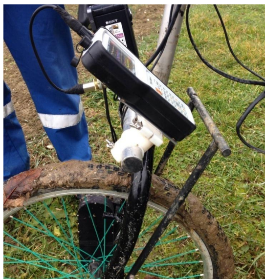
Slika 6c, Nosač instrumenta i video kamere zajedno s enkoderskim odometrom
